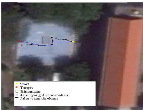
Gambar 10 Hasil Plot jalur robot pada navigasi dengan rintangan
